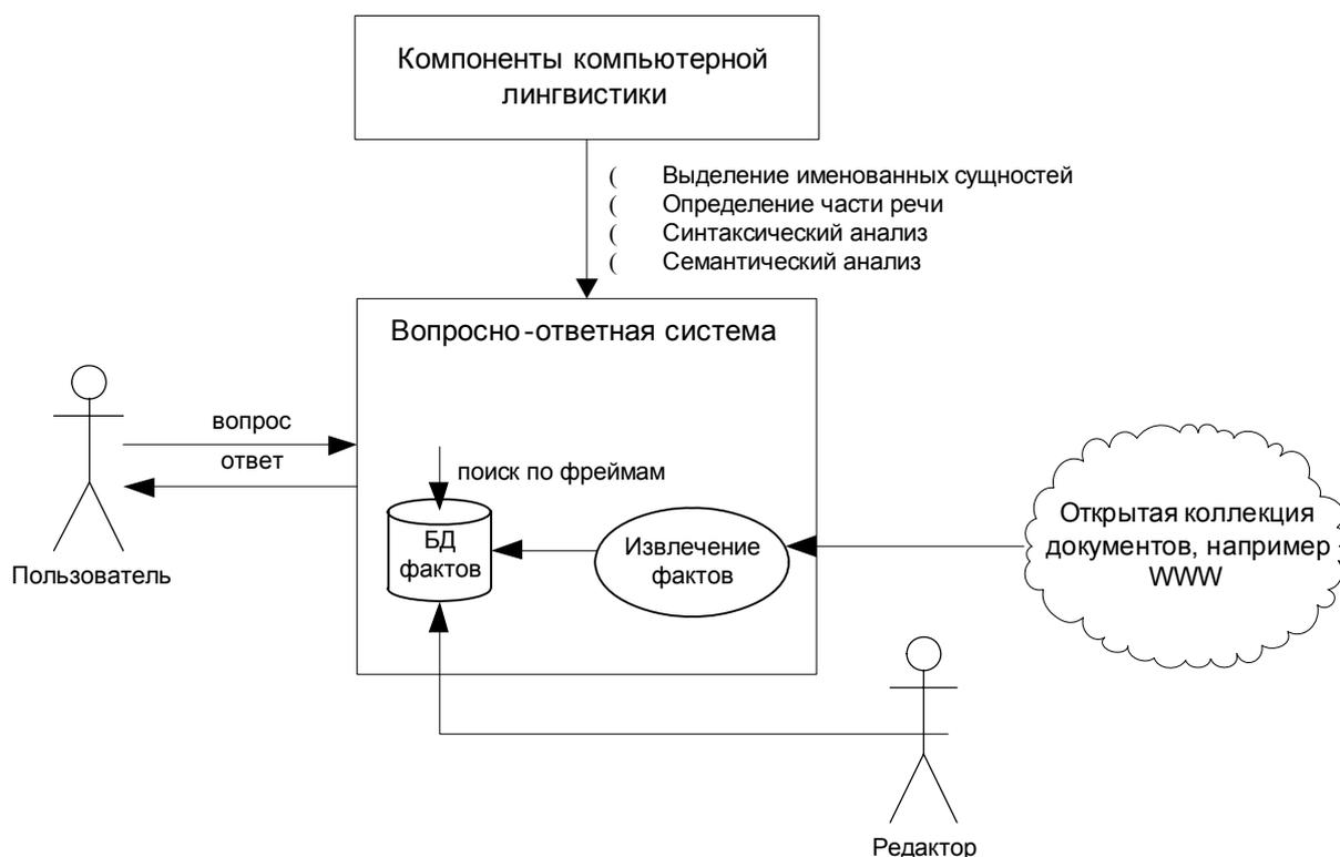
Рис. 3. Обобщённая схема архитектуры вопросно-ответной системы, применяющей принципы построения экспертных систем
